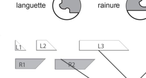
Aligner la première série de démarrage sur la ligne médiane (pour aligner les lames, s'assurer que la ligne passe bien par la pointe du schéma). Toujours laisser un espace de dilatation de 8 mm par rapport au mur. Calculer le nombre de séries de démarrage qui seront nécessaires en prenant pour base la largeur de la pièce. Préparer les séries de démarrage supplémentaires. Vous pouvez connecter les séries de démarrage avec une lame entière.
