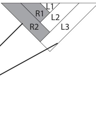
Tout d'abord, suivre le modèle de coupe figurant à l'intérieur de votre carton pour couper les 5 lames (L1, L2, L3, R1, R2) nécessaires à la série de démarrage. On ne peut couper qu'une lame à la fois, ce qui signifie qu'il faut 5 lames au total pour parvenir à confectionner les pièces requises pour une série de démarrage.
