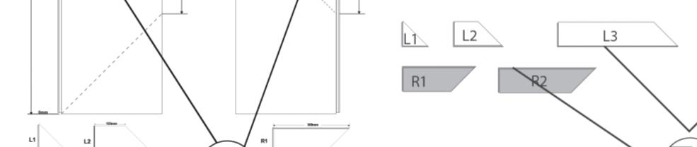
Lijn de eerste startset uit met de middellijn (om de planken uit te lijnen, zorg ervoor dat de lijn door de top van het patroon gaat). Respecteer steeds een uitzetvoeg van 8 mm.
