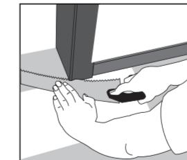
Encadrements de portes et plinthes: Placer une lame avec la partie inférieure dirigée vers le haut contre l'encadrement de la porte. Scier l'encadrement de la porte comme indiqué sur l'image. Puis poser la lame en dessous de l'encadrement de porte scié.
