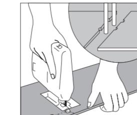
Ouvertures pour les tuyaux: Mesurer le diamètre du tuyau et percer un trou de 20 mm plus large. Scier un morceau et placer la lame sur le sol. Puis remettre le morceau scié en place.
