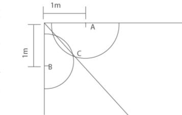
Commencer par le coin gauche opposé à la porte. Utiliser d'abord une lame marquée « L » et placer les languettes contre le mur. Puis prendre la deuxième lame (marquée « R ») et la placer perpendiculairement à la première (se référer aux conseils d'encliquetage en bas de cette page). Pour la troisième et la quatrième lame, se référer aux conseils de coupe ci-après. Poursuivre la pose dans le même ordre.
