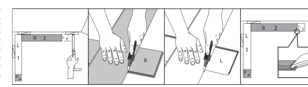
Ce schéma de pose est donné à titre d'exemple, cela dépend de la forme de la pièce. Il est important de toujours commencer par les lames placées contre les murs.
