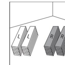
Door de L en R planken in aparte stapels te leggen zal het gemakkelijker zijn om de juiste plank te nemen als de L of R markering afgesneden is.
