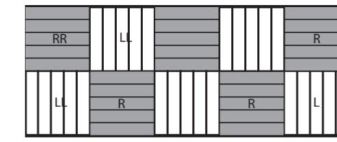
Deze installatiemethode bestaat uit het groeperen van 5 planken met dezelfde profielering.
