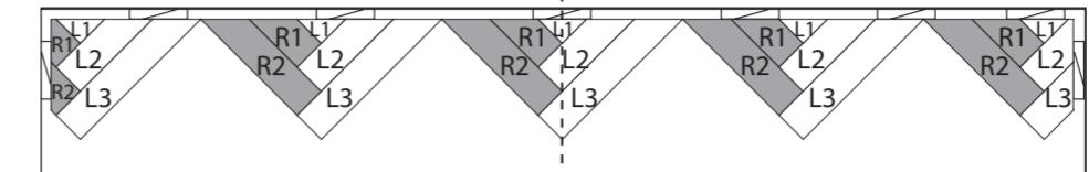
Lijn de eerste startset uit met een krijtlijn die de middellijn van de kamer weergeeft (om de planken uit te lijnen, let erop dat de lijn door de top van het patroon loopt). Hou steeds 8 mm afstand van de muur.
