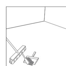
Le sous-plancher doit être plan, sec et propre. Les agrafes pour moquettes ou les résidus de colle doivent être ôtés et le sol doit être propre pour assurer une pose correcte.
