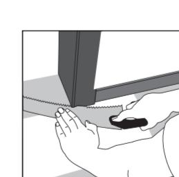
Openingen voor buizen: Boor het gat voor een buis altijd 16 mm groter dan de diameter van de buis. Zaag het deel af zoals te zien is op de tekening, en leg de tegel op zijn plaats. Daarna leg je het uitgezaagde stuk op zijn plaats.
