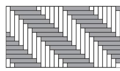
Teken met behulp van een potlood, touw en meetlat een lijn in een hoek van 45° zoals op de tekening. Die lijn zal gebruikt worden om het patroon uit te lijnen. Plaats daarna de afstandsblokjes langs de muur en hou 8 mm afstand.
