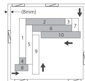
**SNIJTIPS:** Om de 3° (L), de 4° (R) en de andere planken die met de korte zijde tegen de muur komen te installeren, meet de lengte van de plank en snij vervolgens. Let erop om de correcte zijde van de plank te gebruiken (zie tekeningen hiernaast).
