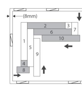
**CONSEILS POUR LA COUPE:** Pour installer la 3e (L), la 4e (R) et n'importe quelle autre lame dont le côté court se trouvera contre le mur, mesurer la longueur de la lame afin de l'adapter et de la couper en conséquence. S'assurer d'utiliser le bon côté de la lame (voir les images ci-dessous).
