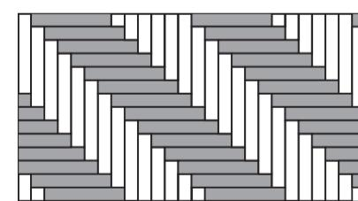
À l'aide d'un crayon, d'un fil et d'une règle, tracer une ligne à 45° qui sera utilisée pour aligner le dessin conformément à l'image. Vous pouvez ensuite commencer à placer vos écarteurs en décalé le long du mur en ménageant un espace de dilatation de 8 mm par rapport au mur.
